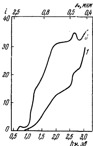
Рис. 4.20. Спектральная зависимость фотопроводимости для свежеращенного кристалла ВаО [20] (кривая 1); то же при одновременном облучении ультрафиолетом (кривая 2).
